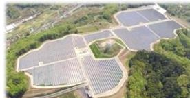
14haに太陽電池パネル約4万枚を施設。開発時には県内3番目の出力規模で、一般家庭2,870世帯分を発電
