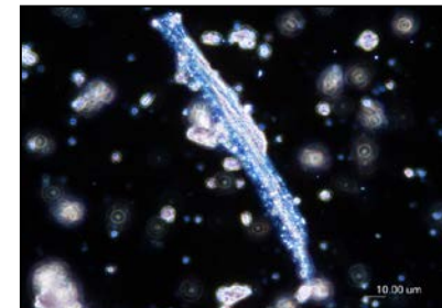
人体に無害化な形質変化されたアスベスト繊維
