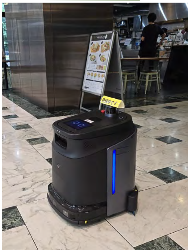
清掃範囲をデジタルマッピングした清掃ロボ
